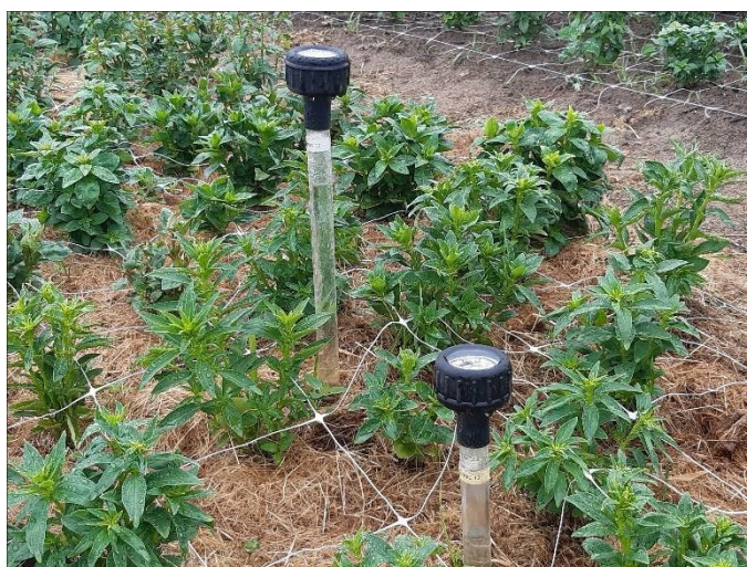
Foto 1: links: Campbell CS650-sensoren werden in de ongestoorde bodem ingebracht op 15 cm diepte om het vochtgehalte op te volgen tijdens de proef, rechts: tensiometers op 15 en 30 cm diepte tussen A. majus .
