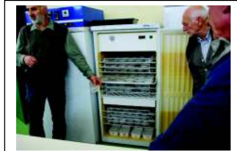
Figuur 2 Broedstoof voor het testen van schimmelaantastingen
