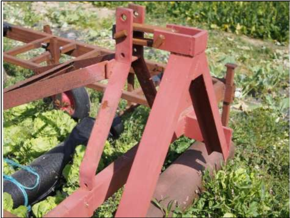
Sleufgat in de kop: machine loopt op eigen gewicht en volgt de kromming van het perceel
