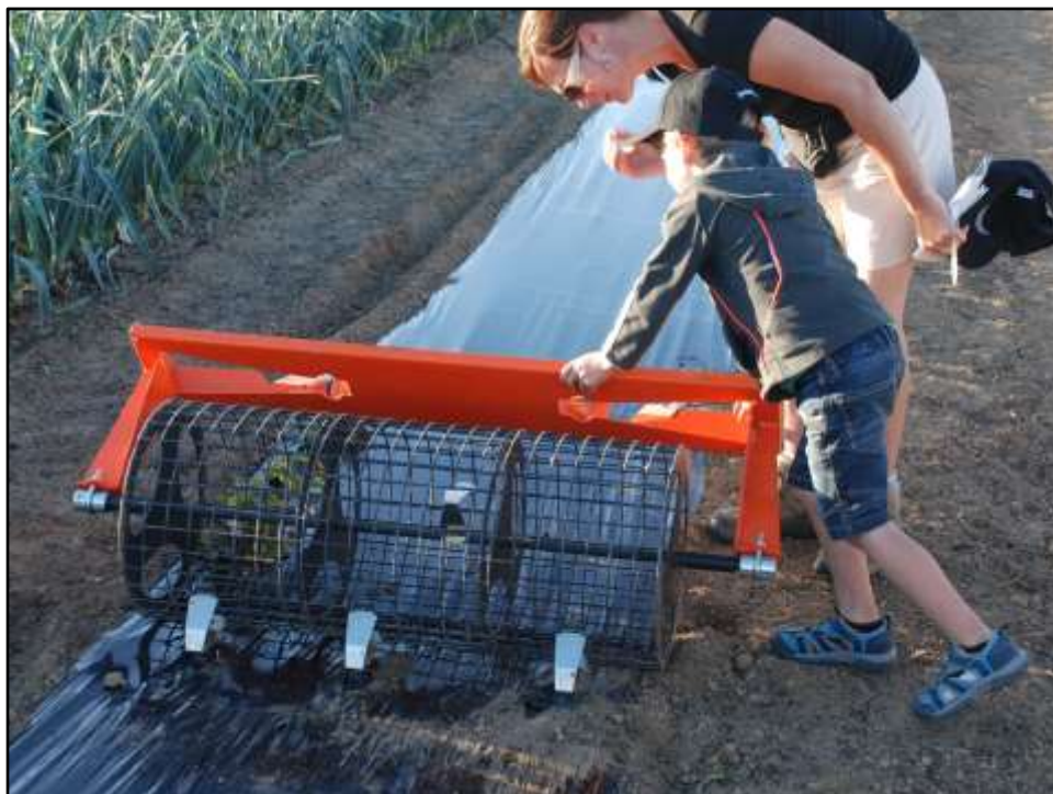
Merkerrol van Terrateck om plantgaten te steken in folie op kleine schaal
