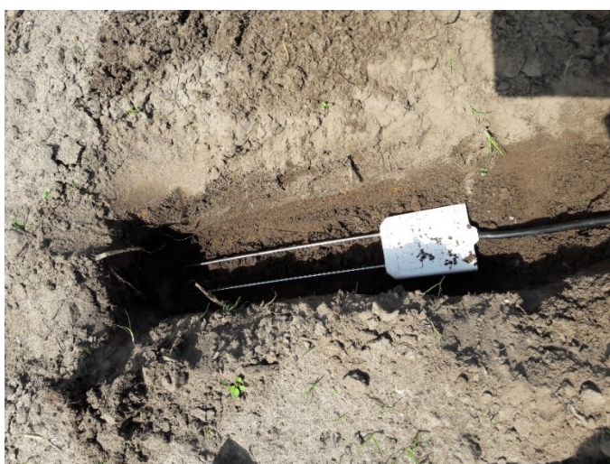
Foto 1: links: Campbell CS650-sensoren werden in de ongestoorte bodem ingebracht op 15 cm diepte om het vochtgehalte op te volgen tijdens de proef, rechts: tensiometers op 15 en 30 cm diepte tussen A. majus .
