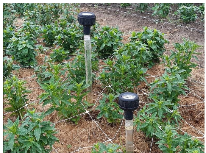
Foto 1: links: Campbell CS650-sensoren werden in de ongestoorte bodem ingebracht op 15 cm diepte om het vochtgehalte op te volgen tijdens de proef, rechts: tensiometers op 15 en 30 cm diepte tussen A. majus .
