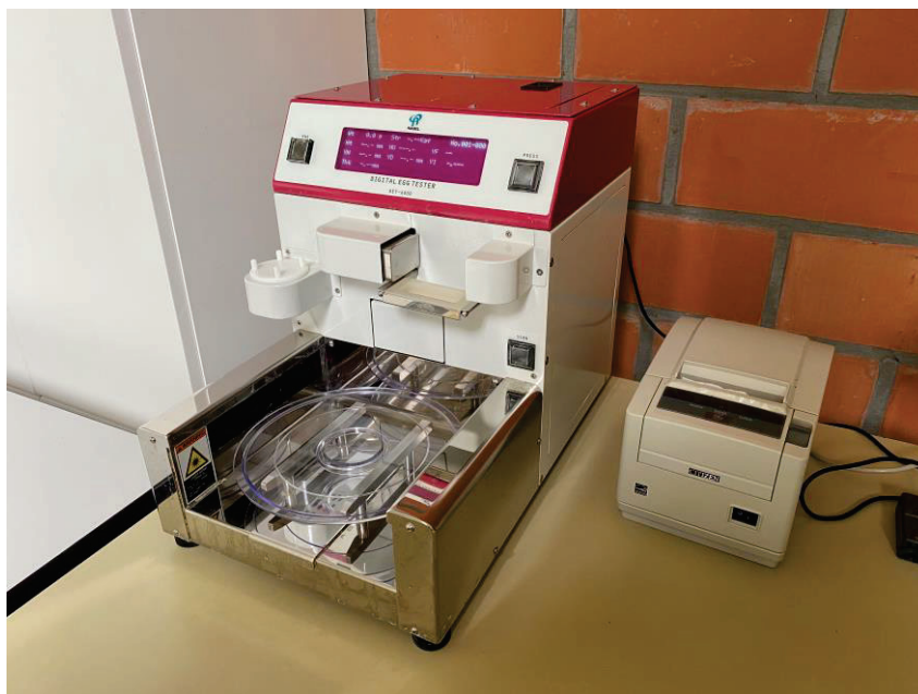
Fig. 6: Digitale eikwaliteit tester DET6500 (Proefbedrijf Pluimveehouderij)
