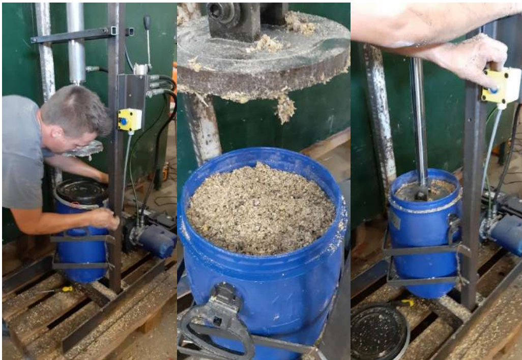
Figuur 21 – Inkuilen in vaten van 30 liter
