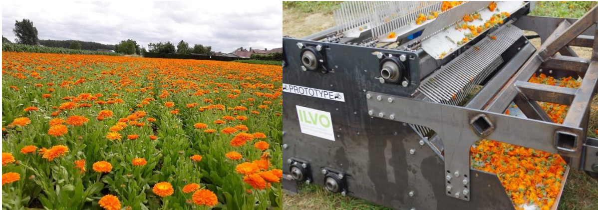
Figuur 2: Links: Ideale gewastoeestand voor een kwalitatieve bloemoogst. De bloemen komen voldoende boven het bladerdek uit zodat weinig groene delen mee geoogst worden. Rechts: ILVO ontwikkelde drie prototypes voor een machinale bloemoogst. Het derde prototype gaf de beste plukresultaten.
